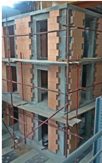
Ispitivanje ponašanja zidane konstrukcije građene po sustavu omeđenog zida/Potresna ploča Zavod za građevinarstvo Slovenije (ZAG), Ljubljana; voditelji projekta doc. dr. Matija Gams i prof. dr. Miha Tomažević
